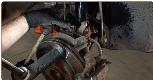
**57** Vyčistite montážny otvor disku kolesa. Použite drôtenú kefu. Natriete kontaktný povrch. Použite medené mazivo.
