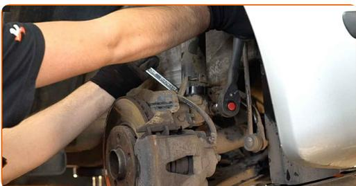
**14** Odpojte brzdovú hadičku zo vzpery tlmiča. Použite páčidlo.
