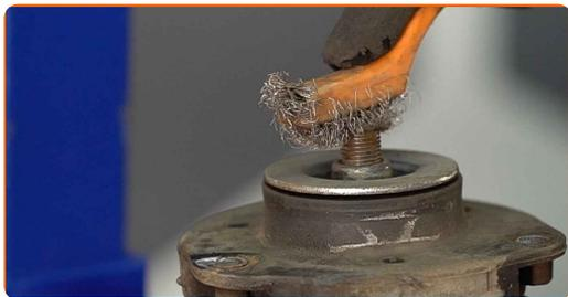
**31** Odstráňte skrutku piestnice vzpery. Použite kombinačný kľúč č.21 Použite imbusový kľúč č. H7. Použite ráčňový kľúč.
