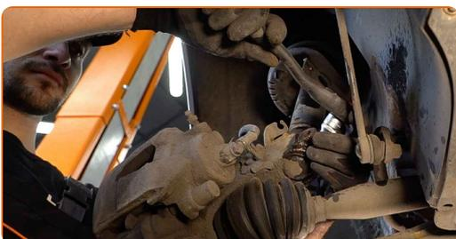
**17** Vyčistite montážnu pozíciu guľového čapu. Použite drôtenú kefu. Použite sprej WD-40.
