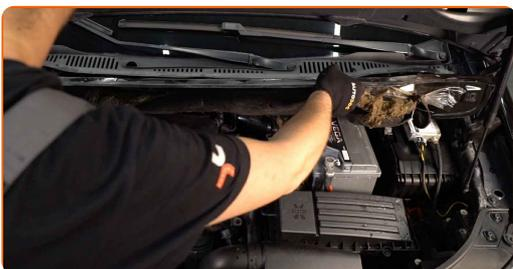
6 Vyčistite upevňovacie prvky vrchného ložiska vzpery tlmiča. Použite drôtenú kefu. Použite sprej WD-40.
