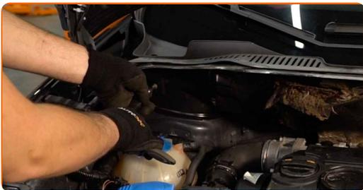
5 Odstráňte odvodový kanálik pod stieračmi čelného skla.
