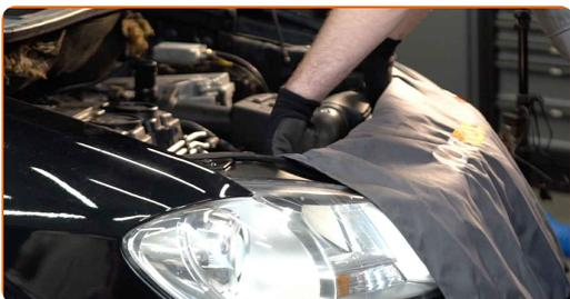
**3** Odstráňte tesnenie mriežky na odvádzanie vody.
