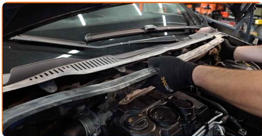
**75** Zaskrutkujte upevňovacie prvky odvodového kanálika pod stieračmi čelného skla. Použite hviezdicový Torx T30.
