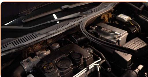
4 Odskrutkujte upevňovacie prvky odvodového kanálika pod stieračmi čelného skla. Použite hviezdicový Torx T30.
