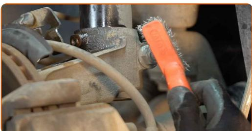
**19** Odskrutkujte spodné upevnenie vzpery tlmiča. Použite nástavec č.18. Použite XZN č. 12. Použite vratidlo. Použite ráčňový kľúč.
