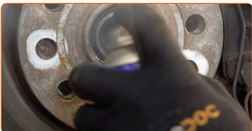
**23** Vyčistite všetky spojenia ramena. Použite drôtenú kefu. Použite sprej WD-40.
