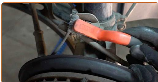
**17** Odskrutkujte skrutku a odstráňte montážnu svorku brzdovej hadičky a kábel ABS. Použite kombinačný kľúč č.11.
