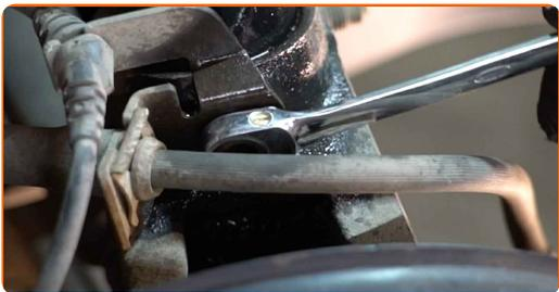
**18** Vyčistite upevňovacie prvky spájajúce vzperu tlmiča a hlavu ložiska čapu kola. Použite drôtenú kefu. Použite sprej WD-40.
