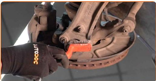
**24** Odskrutkujte upevňovací prvok spojujúci guľový čap a ovládacie rameno odpruženia. Použite nástavec č.16. Použite vratidlo.
