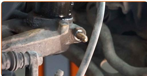
**49** Zaskrutkujte upeňovací prvok, ktorý spája tlmič k hlave ložiska čapu. Použite nástavec č.16.
