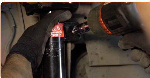
**57** Upevnite brzdovú hadičku na vzperu. Pripojte upevňovací prvok ABS snímača a jeho kábla k vzpere tmiča.
