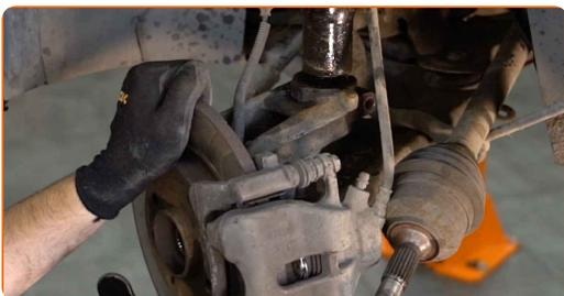
**28** Odskrutkujte upevňovacie prvky na vrchnej strane uloženia vzpery tmiča. Použite nástavec č.22.
