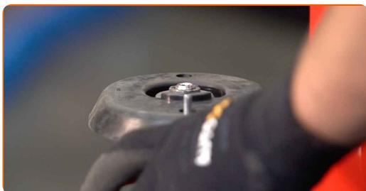
**41** Upevnite maticu piestu vzpery tlmiča. Použite imbusový kľúč č. H7. Použite nástavec č.19. Použite momentový kľúč. Utiahnite ju krútiacim momentom 60 Nm.
