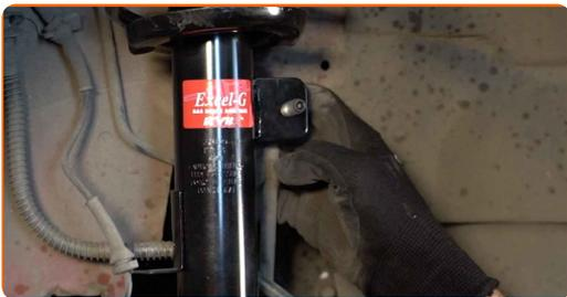
**56** Utiahnite upevňovací prvok vzpery stabilizátora. Použite nástavec č.17.
