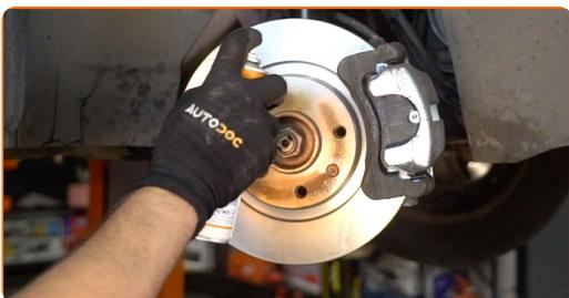
**65** Vyčistite povrch brzdového kotúča. Použite čistič brzd.
