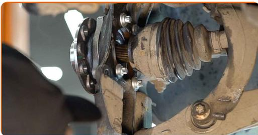
**35** Vyčistite montážnu pozíciu guľového čapu. Použite drôtenú kefu. Použite sprej WD-40.
