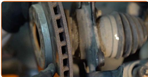
**19** Vyčistite upevnenie spájajúce guľový čap a hlavu ložiska čapu. Použite drôtenú kefu. Použite sprej WD-40.
