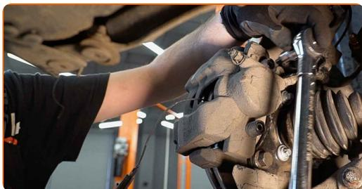
**52** Zapojte konektor snímača opotrebenia brzdovej platničky.
