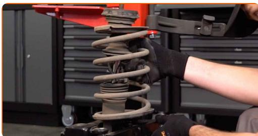
Výmena: jednotka pruženia, tlmič pruženia – Renault Twingo C06. Odporučajú odborníci z AUTODOC:
