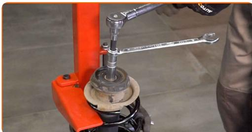
Výmena: jednotka pruženia, tlmič pruženia – Renault Twingo C06. Tip od odborníkov z AUTODOC:
