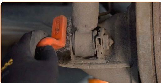
**11** Odskrutkujte spodné upevnenie vzpery tlmiča. Použite nástavec č.18. Použite vratidlo.
