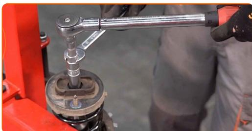
**Výmena: pružin podvozku – Renault Twingo C06. Tip od AUTODOC:**
