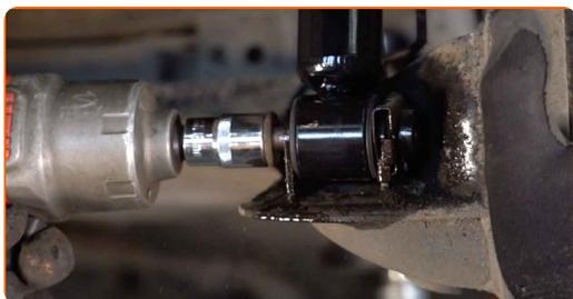
**36** Podoprite nosník zadného odpruženia kolies. Použite zdvihák s hydraulickými prevodmi.
