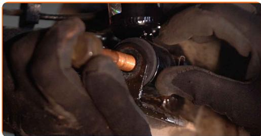
**35** Zaskrutkujte spodný upevňovací prvok tmiča pruženia. Použite nástavec č.18.
