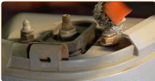
**4** Uvoľníte vrchný upevňovací prvok ložiska vzpery tlmiča. Použite nástavec č.13. Použite ráčňový kľúč.
