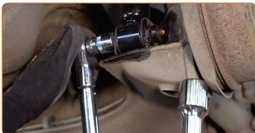
**38** Odstráňte upevnenie spod nosníka zadnej nápravy.
