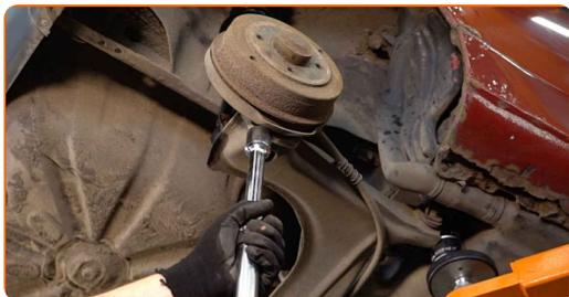
**37** Uťahnite spodné upevnenie tmiča. Použite nástavec č.18. Použite momentový kľúč. Uťahnite ju krútiacim momentom 95 Nm.
