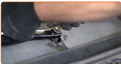
Výmena: jednotka pruženia, tlmič pruženia – Ford Focus MK2. Tip od AUTODOC:
