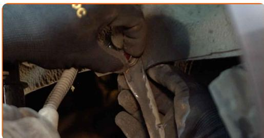
**41** Zaskrutkujte upevnenie držiaka zosilňujúcej tyče nárazníka. Použite nástavec č.18. Použite momentový kľúč. Utiahnite ju krútiacim momentom 70 Nm.
