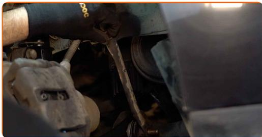
**40** Zaskrutkujte upevnenie držiaka zosilňujúcej tyče nárazníka. Použite nástavec č.12. Použite ráčňový kľúč.
