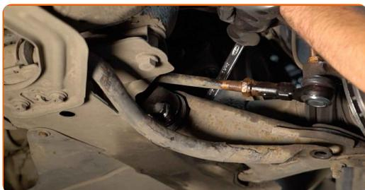
**17** Vyčistite upevnenie spájajúce guľový čap a hlavu ložiska čapu. Použite drôtenú kefu. Použite sprej WD-40.
