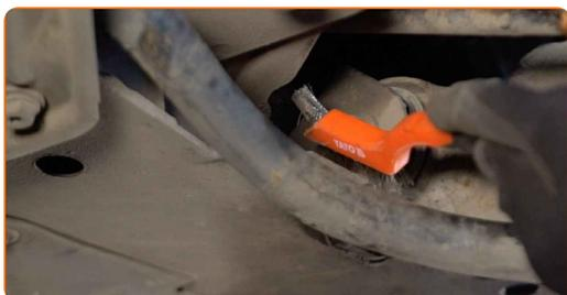
**16** Odskrutkujte upevnenie zadného ramena. Použite kombinačný kľúč č.18. Použite nástavec č.18. Použite vratidlo.
