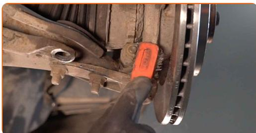
**18** Odskrutkujte upevnenie guľového čapu a tiahla riadenia. Použite kombinačný kľúč č.16. Použite nástavec č.16.
