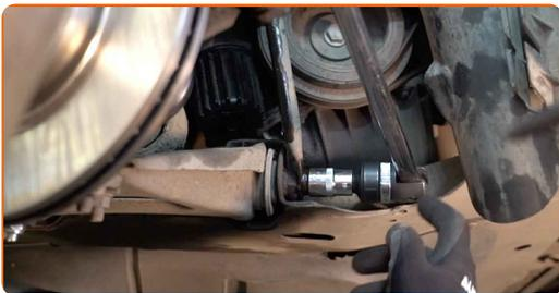
**9** Odskrutkujte upevňovacie prvky držiaka zosilňovacej tyče nárazníka. Použite nástavec č.12. Použite vratidlo.
