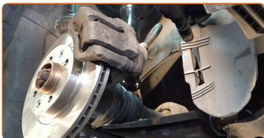
**44** Nainštalujte priečne stabilizačné rameno. Použite páčidlo.
