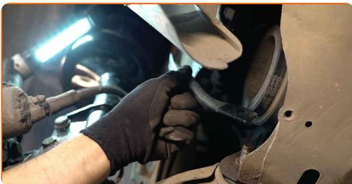
**11** Vyčistite všetky spojenia ramena. Použite drôtenú kefu. Použite sprej WD-40.
