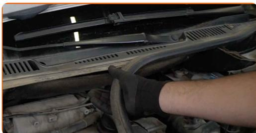
**4** Vyčistíte upevňovacie prvky plastového krytu pod stierače čelného skla. Použite drôtenú kefu. Použite sprej WD-40.
