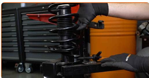
**49** Natrite montážny prvok vzpery tlmiča na hlave ložiska čapu kola. Použite drôtenú kefu. Použite sprej WD-40.
