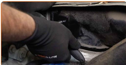
**6** Odstráňte odvodový kanálik pod stieračmi čelného skla.
