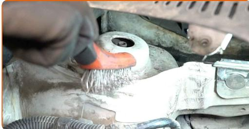
8 Uvoľnite horné upevňovacie prvky tlmiča. Použite nástavec č.13. Použite ráčňový kľúč.
