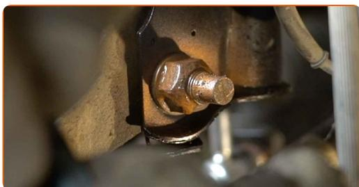
**56** Natrite povrch, kde je brzdový kotúč v kontakte s ráfikom kolesa. Použite medené mazivo.
