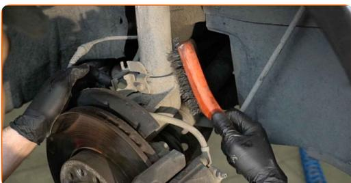
**13** Odskrutkujte spodný upevňovací prvok spájajúci vzperu tlmiča a hlavu ložiska čapu kola. Použite nástavec č.17. Použite ráčňový kľúč.
