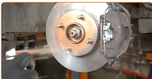
**57** Vyčistite povrch brzdového kotúča. Použite čistič brzd.
