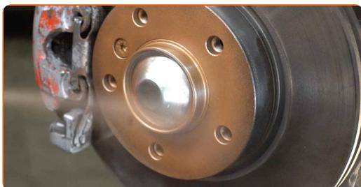
**51** Vyčistite povrch brzdového kotúča. Použite čistič brzd.
