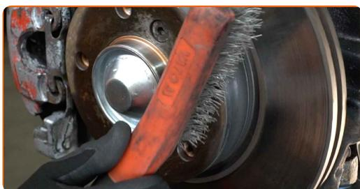
**50** Natrite povrch, kde je brzdový kotúč v kontakte s ráfikom kolesa. Použite medené mazivo.
