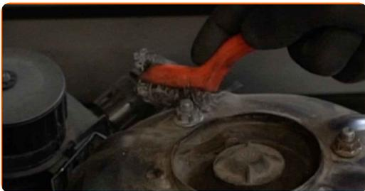
**5** Uvoľnite horné upevňovacie prvky tlmíča. Použite nástavec č.13. Použite ráčňový kľúč.
