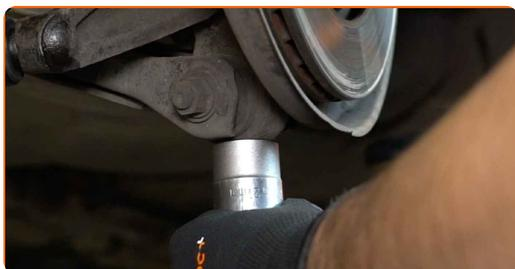
**31** Utiahnite spodné upevnenie tlmiča. Použite nástavec č.17. Použite momentový kľúč. Utiahnite ju krútiacim momentom 100 Nm.
