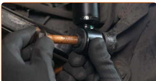
**29** Zaskrutkujte vrchný upevňovací prvok tlmiča. Neuťahujte ho.
