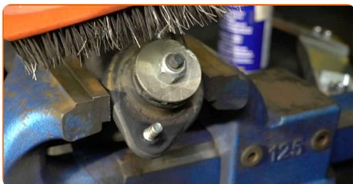
**19** Odstráňte upevnenie tyče piestu tlmiča. Použite rozperný nástavec na demontáž tlmičov DDN<sup>®</sup>6. Použite nástavec č.16. Použite ráčňový kľúč.
