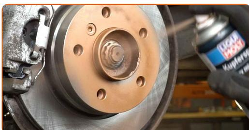
**36** Vyčistíte povrch brzdového kotúča. Použite čistič brzd.
