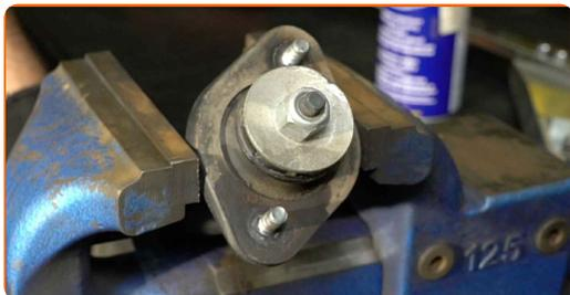
**18** Vyčistite upevňovací prvok tyčky tlmiča. Použite drôtenú kefu. Použite sprej WD-40.
