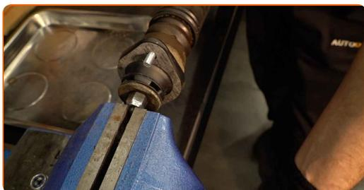
23 Zaskrutkujte vrchné uloženie piestu vzpery tlmiča. Použite kombinačný kľúč č.17. Použite nastaviteľný kľúč. Použite momentový kľúč. Uťahnite ju krútiacim momentom 20 Nm.
