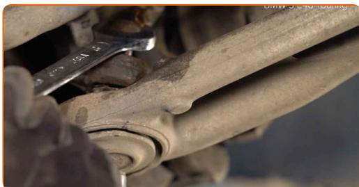
56 Podoprite rameno. Použite zdvihák s hydraulickými prevodmi.
