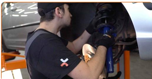
46 Zaskrutkujte vrchné upevnenie uloženia vzpery tlmiča. Použite nástavec č.13. Neuťahujte ho.
