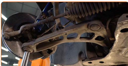
57 Zaskrutkujte upevňovací prvok spájajúci guľový čap k hlave ložiska čapu nápravy. Použite kombinačný kľúč č.19. Použite momentový kľúč. Utiahnite ju krútiacim momentom 65 Nm.
