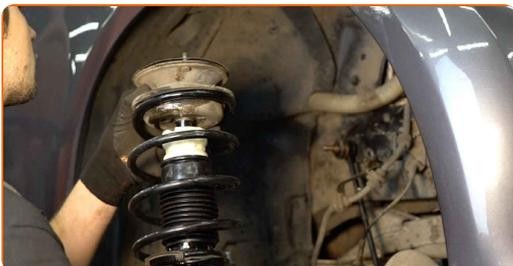
**49** Zaskrutkujte vrchné upevnenie uloženia vzpery tlmiča. Použite nástavec č.13. Neuťahujte ho.
