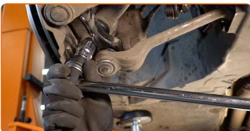
**14** Odskrutkujte koncovú skrutku kĺbu riadenia. Použite kombinačný kľúč č.18. Použite hviezdicový Torx T30. Použite ráčňový kľúč.
