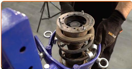
**31** Odstráňte kryt ložiska vzpery tlmiča. Použite páčidlo.
