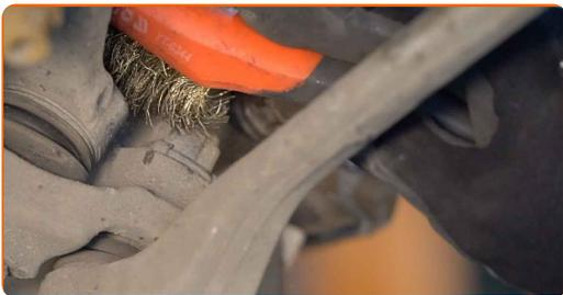
**13** Odskrutkujte upevňovací prvok spájajúci guľový čap predného ovládacieho ramena k hlave ložiska čapu kola. Použite nástavec č.21. Použite vratidlo.
