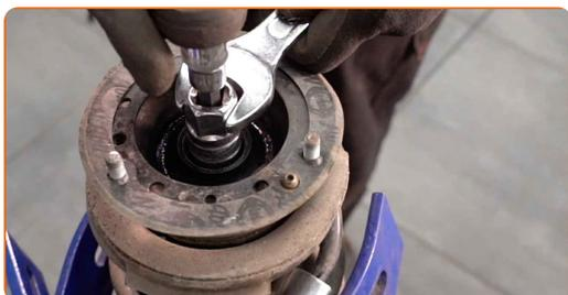
**34** Odstráňte vrchné uloženie vzpery. Použite páčidlo.
