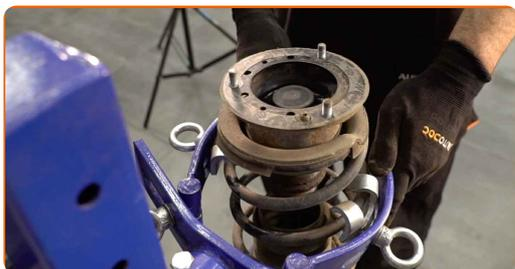
**30** Odstráňte kryt ložiska vzpery tlmiča. Použite páčidlo.
