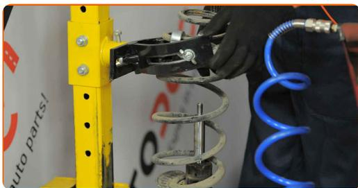
**49** Odstráňte starý tlmič z hydraulického kompresora na vinuté pružiny.
