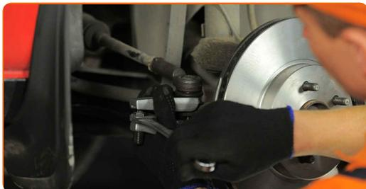
**9** Vyčistite upevňovacie prvky vzpery stabilizátora. Použite drôtenú kefu. Použite sprej WD-40.
