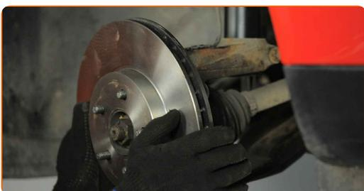
**86** Vyčistite montážne otvory brzdového strmeňa a jeho držiaka. Použite drôtenú kefu. Použite sprej WD-40.
