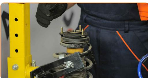
**55** Upevnite maticu piestu vzpery tlmiča. Použite plochý skrutkovač. Použite nástavec č.18. Použite momentový kľúč. Utiahnite ju krútiacim momentom 58 Nm.
