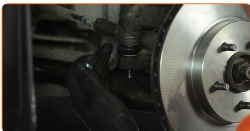
**91** Utiahnite upevňovaciu maticu spájajúcu čap tiahla riadenia k hlave ložiska čapu kolesa. Použite nástavec č.17. Použite momentový kľúč. Utiahnite ju krútiacim momentom 40 Nm.
