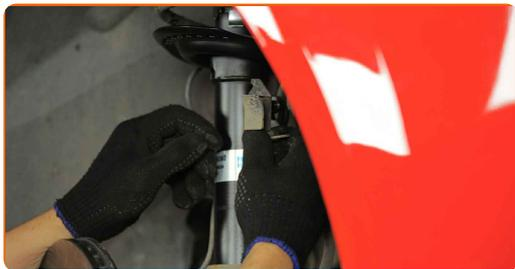
**94** Upevnite upevňovaciú svorku brzdovej hadičky k vzpere tlmiča. Použite nástavec č.15. Použite momentový kľúč. Uťahnite ju krútiacim momentom 31 Nm.
