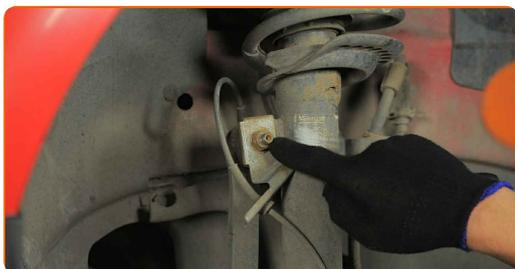
**10** Odskrutkujte upevnenie spájajúce vzperu stabilizátora k vzpere tlmiča. Použite kombinačný kľúč č.17 Použite imbusový kľúč č. H5. Použite ráčňový kľúč.
