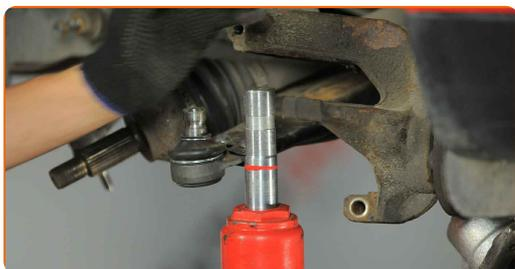
**68** Uvoľnite spodný upevňovací prvok spájajúci vzperu tmiča a hlavu ložiska čapu kola. Použite plochý sekáč na kov. Použite kladivo.
