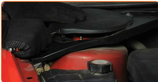
**34** Vyčistite upevňovacie prvky vrchného ložiska vzpery tlmiča. Použite drôtenú kefu. Použite sprej WD-40.
