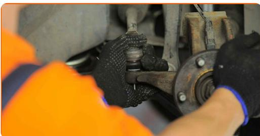
**66** Utiahnite upevňovaciu maticu spájajúcu čap tiahla riadenia k hlave ložiska čapu kola. Použite nástavec č.15. Použite momentový kľúč. Utiahnite ju krútiacim momentom 40 Nm.
