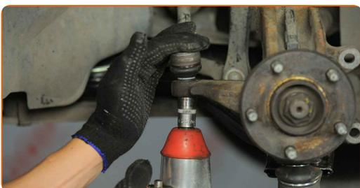
**67** Natrite upevnenie spájajúce čap tiahla riadenia k hlave ložiska čapu. Použite medené mazivo.
