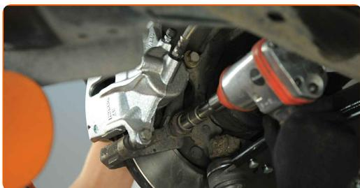
**64** Upevnite brzdovú hadičku na vzperu.
