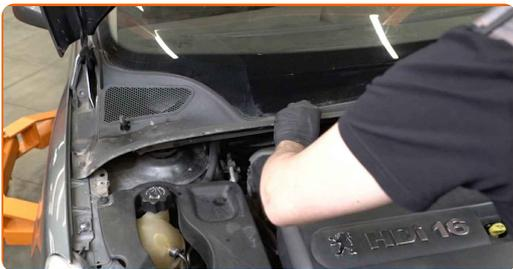
**73** Utiahnite upevňovacie prvky plastového krytu pod stierače. Použite nástavec č.10. Použite ráčňový kľúč.
