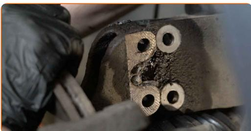
**30** Odskrutkujte upevňovacie prvky na vrchnej strane uloženia vzpery tlmiča.
