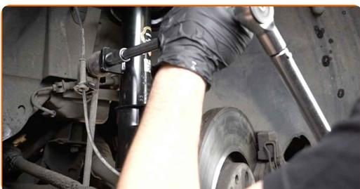
**59** Namažte všetky spojenia vzpery stabilizátora. Použite medené mazivo.
