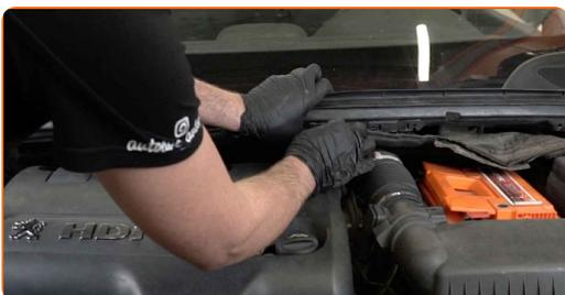
**75** Utiahnite upevnenia nádrčky brzdovej kvapaliny. Použite hviezdicový Torx T20. Použite ráčňový kľúč.
