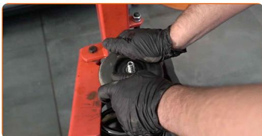
44 Upevnite maticu piestu vzpery tmiča. Použite nástavec č.18. Použite imbusový kľúč č. H7. Použite momentový kľúč. Utiahnite ju krútiacim momentom 69 Nm.
