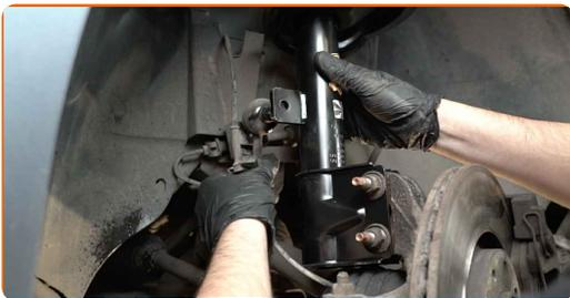
**58** Utiahnite upevnenie spájajúce vzperu stabilizátora k vzpere tlmiča. Použite nástavec č.15. Použite momentový kľúč. Utiahnite ju krútiacim momentom 36 Nm.
