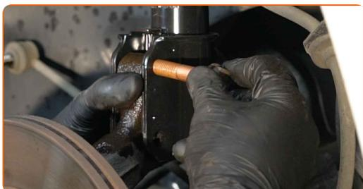
**51** Zaskrutkujte upevňovací prvok, ktorý spája tlmíč k hlave ložiska čapu. Použite kombinačný kľúč č.18. Použite nástavec č.18. Použite ráčňový kľúč.
