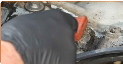
**9** Uvoľnite vrchný upevňovací prvok ložiska vzpery tlmíča. Použite nástavec č.13. Použite ráčňový kľúč.
