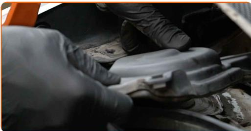
**8** Vyčistite upevňovacie prvky vrchného ložiska vzpery tlmíča. Použite drôtenú kefu. Použite sprej WD-40.
