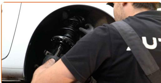
**47** Zaskrutkujte vrchné upevnenie uloženia vzpery tlmiča. Neťahujte ho.
