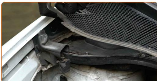
**6** Odsrutkujte upevňovacie prvky krytu uloženia tlmiča. Použite nástavec č.10. Použite ráčňový kľúč.
