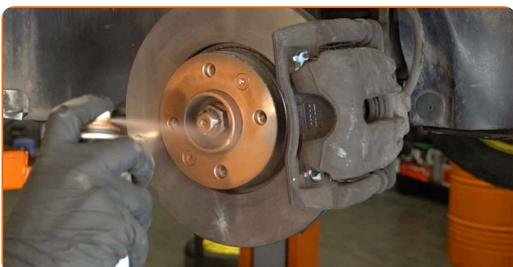
**61** Vyčistite povrch brzdového kotúča. Použite čistič brzd.
