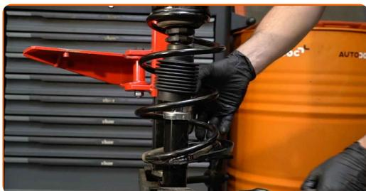
**45** Natrite montážne pozície tlmiča pruženia. Použite drôtenú kefu. Použite sprej WD-40.
