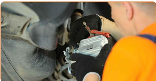
**20** Zaistite lanko parkovacej brzdy pomocou zádržného krúžku. Použite plochý skrutkovač.
