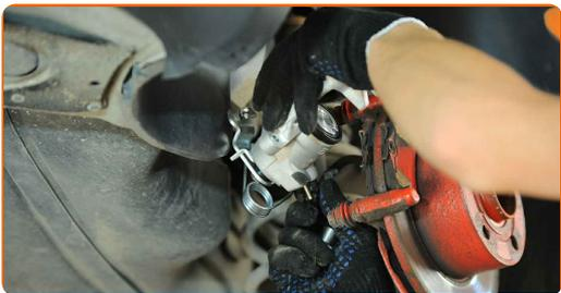
**18** Utiahnite upevňovacie prvky brzdového strmeňa. Použite kombinačný kľúč č.15. Použite nástavec č.13. Použite momentový kľúč. Utiahnite ju krútiacim momentom 35 Nm.
