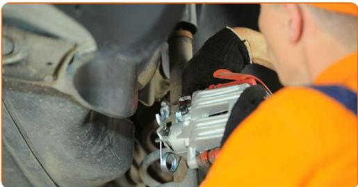
**21** Odpojte skrutku prvku na odvzdušnenie brzd. Použite kľúč na prevlečné matice #10.
