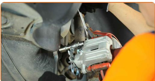
**19** Nainštalujte lanko parkovacej brzdy na držiak brzdového strmeňa. Použite plochý skrutkovač.
