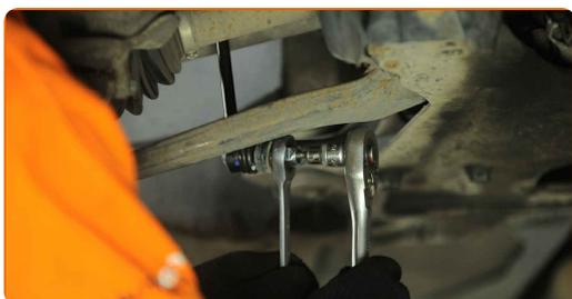
**13** Utiahnite upevnenie spájajúce vzperu stabilizátora k vzpere tlmiča. Použite kombinačný kľúč č.19 Použite imbusový kľúč č. H6. Použite momentový kľúč. Utiahnite ju krútiacim momentom 65 Nm.
