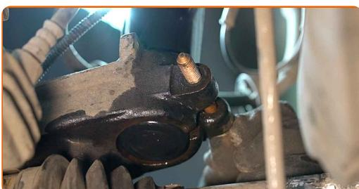
**52** Utiahnite spodné upevňovacie prvky tlmiča. Použite nástavec č.16. Použite momentový kľúč. Utiahnite ju krútiacim momentom 55 Nm.
