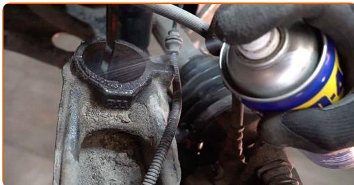
**49** Uvoľnite spodný upevňovací prvak spájajúci vzperu tlmiča a hlavu ložiska čapu kolesa. Použite plochý sekáč na kov. Použite kladivo.
