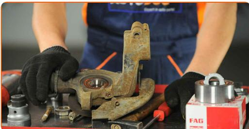
**37** Odstráňte náboj kolesa z kĺbu riadenia. Použite sadu vložky a orechu ložiska. Použite kladivo.
