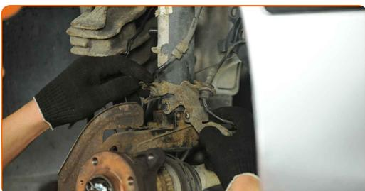
**65** Utiahnite držiak ABS kábla. Použite nástavec č.10. Použite momentový kľúč. Utiahnite ju krútiacim momentom 10 Nm.
