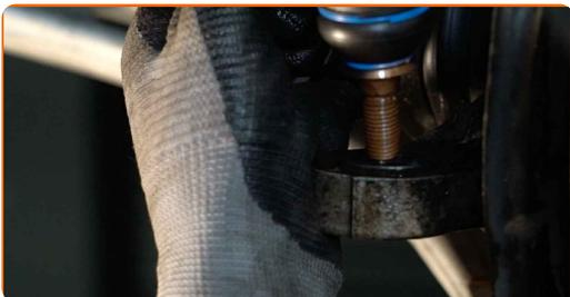
**63** Utiahnite upevňovaciu maticu spájajúcu čap tiahla riadenia k hlave ložiska čapu kolesa. Použite nástavec č.17. Použite momentový kľúč. Utiahnite ju krútiacim momentom 35 Nm.
