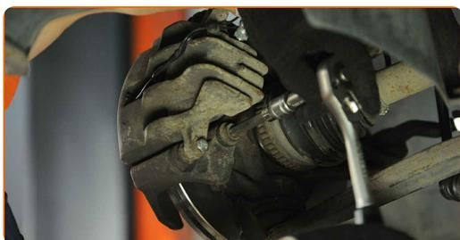
**76** Zapojte konektor snímača opotrebenia brzdovej platničky.
