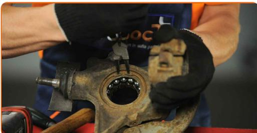
**39** Vytlačte ložisko náboja kolesa. Použite sadu vložky a orechu ložiska.
