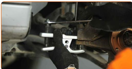
**22** Vyčistite upevnenie, ktoré spája rameno zavesenia kolies ku guľovému čapu. Použite drôtenú kefu. Použite sprej WD-40.
