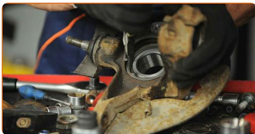
**44** Rozoberte vnútorný krúžok ložiska, ktorý zostal na náboji. Použite sadu vložky a orechu ložiska. Použite separátor ložísk.
