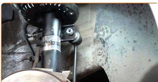
**60** Utiahnite upevnenie spájajúce vzperu stabilizátora k vzpere tlmiča. Použite nástavec č.16. Použite momentový klíč. Utiahnite ju krútiacim momentom 40 Nm.
