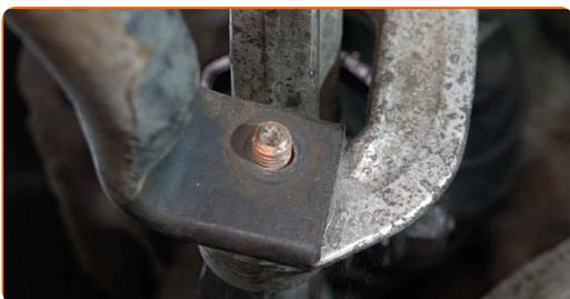
**76** Utiahnite upevňovací prvok vzpery stabilizátora. Použite kombinačný kľúč č.16 Použite nástavec č.16. Použite ráčňový kľúč.
