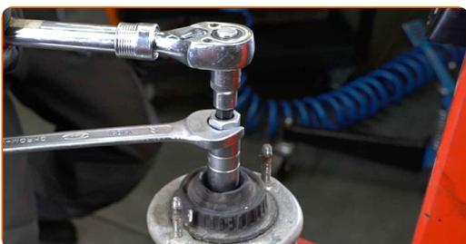
**40** Odstráňte horné uloženie tlmiča. Použite páčidlo.
