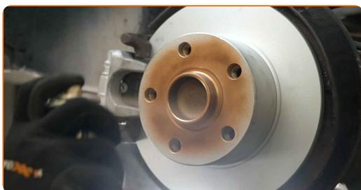
**36** Vyčistite povrch brzdového kotúča. Použite čistič brzd.
