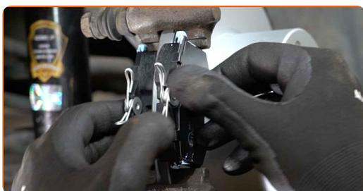
**34** Nainštalujte brzdový strmeň a upevnite ho. Použite kombinačný kľúč č.15. Použite nástavec č.13. Použite momentový kľúč. Utiahnite ju krútiacim momentom 35 Nm.
