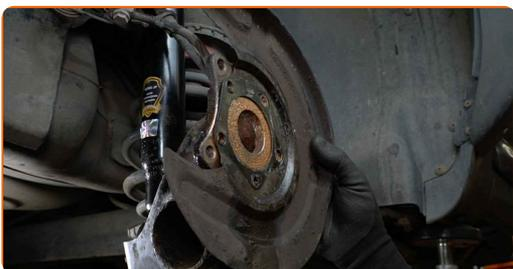
**25** Utiahnite skrutky náboja kola. Použite imbusový kľúč č. H8. Použite momentový kľúč. Utiahnite ju krútiacim momentom 60 Nm.
