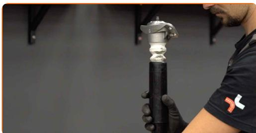
18 Upevnite uloženie tlmiča. Použite kombinačný kľúč č.14. Použite nástavec č.14. Použite momentový kľúč. Uťahnite ju krútiacim momentom 25 Nm.
