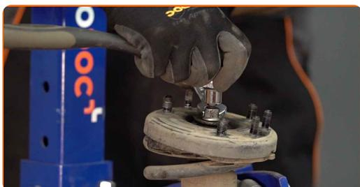
**26** Odstráňte vrchné uloženie vzpery. Použite páčidlo.
