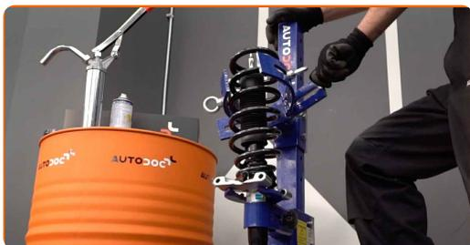
**35** Natrite upevnenia ložiska vzpery tlmiča. Použite sprej WD-40.
