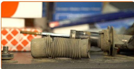
Výmena: jednotka pruženia, tlmič pruženia – Honda Accord VIII CU. Tip od AUTODOC:
