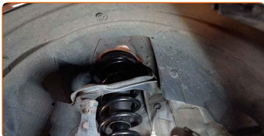
**41** Zaskrutkujte vrchné upevnenie uloženia vzpery tlmiča. Neuťahujte ho.
