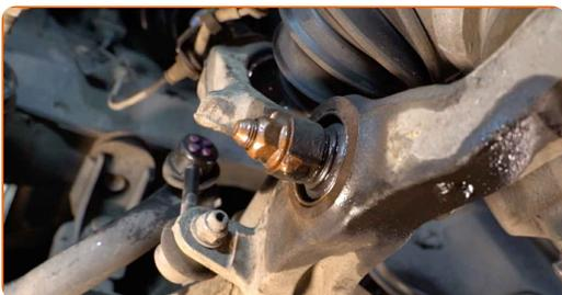
**53** Vyčistite montážny otvor disku kolesa. Použite drôtenú kefu. Natrite kontaktný povrch. Použite medené mazivo.
