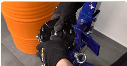
**37** Upevnite maticu piestu vzpery tlmiča. Použite kombinačný kľúč č.17 Použite imbusový kľúč č. H6. Použite momentový kľúč. Uťahnite ju krútiacim momentom 29 Nm.
