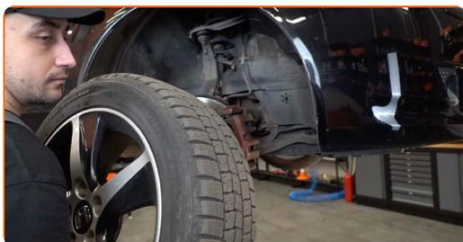
**10** Vyčistite upevňovacie prvky vzpery tlmiča. Použite drôtenú kefu. Použite sprej WD-40.
