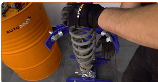
**29** Odstráňte starý tlmič z hydraulického kompresora na vinuté pružiny.
