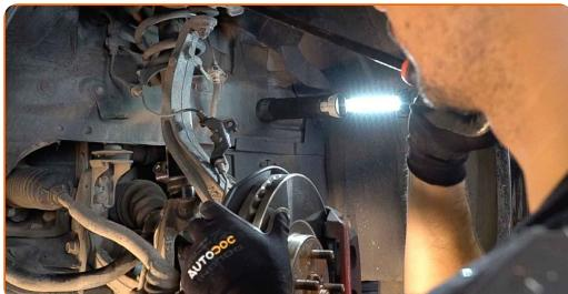
**15** Vyčistite upevňovaciu skrutku, ktorá spája vidlicu tlmiča odpruženia so spodným ovládacím ramenom. Použite drôtenú kefu. Použite sprej WD-40.
