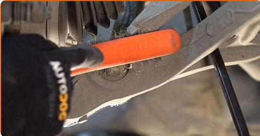
**16** Odskrutkujte upevňovaciu skrutku, ktorá spája vidlicu tlmiča odpruženia so spodným ovládacím ramenom. Použite kombináčny kľúč č.17. Použite nástavec č.17. Použite vratidlo.
