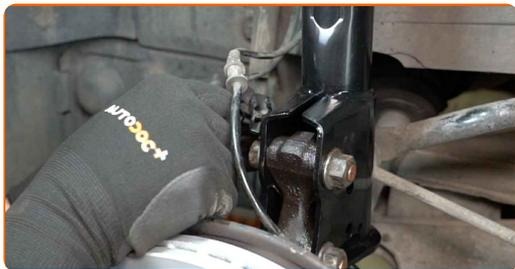
**48** Zapojte vodič snímača opotrebenia brzdovej platničky.
