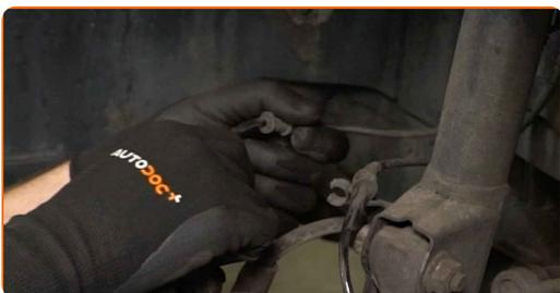
**14** Odpojte vodič snímača opotrebenia brzdovej platničky.
