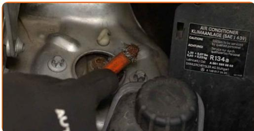
**4** Uvoľnite horné upevňovacie prvky tmiča. Použite nástavec č.E12. Použite ráčňový kľúč.
