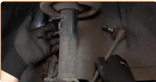
**13** Odpojte vodiče snímača ABS.
