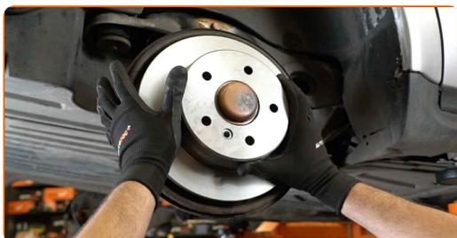
**20** Upevnite upevnenie brzdového kotúča. Použite hviezdicový Torx T30. Použite momentový kľúč. Utiahnite ju krútiacim momentom 9 Nm.
