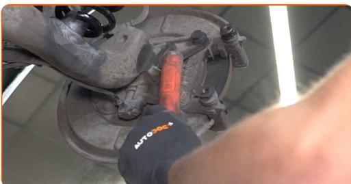
**12** Odskrutkujte upevnenie svorky brzdového strmeňa. Použite nástavec č.16. Použite ráčňový kľúč. Použite vratidlo.
