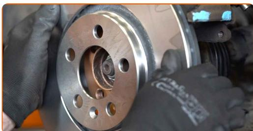
**16** Upevnite upevnenie brzdového kotúča. Použite hviezdicový Torx T30. Použite momentový kľúč. Utiahnite ju krútiacim momentom 4 Nm.
