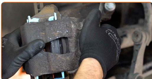
Výmena: brzdových kotúčov – Audi A3 8L1. AUTODOC odporúča:
