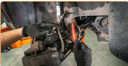
**13** Odskrutkujte upevňovací prvok spojujúci guľový čap a ovládacie rameno odpruženia. Použite nástavec č.13.
