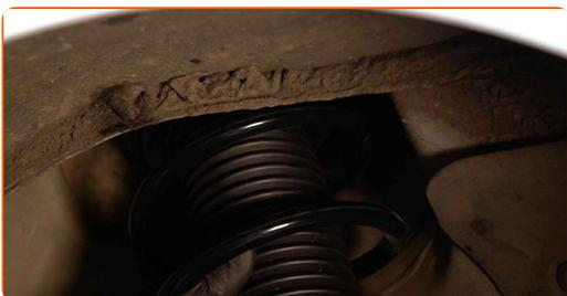
**48** Zaskrutkujte vrchné upevnenie uloženia vzpery tlmiča. Neuťahujte ho.
