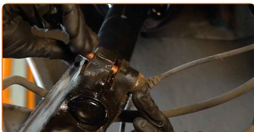
**52** Vyčistite drážky homokinetického kĺbu hnacieho hriadeľa. Použite drôtenú kefu. Použite sprej WD-40.
