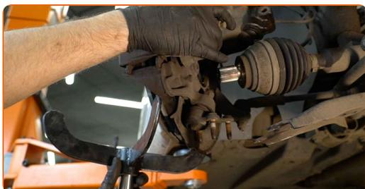
**26** Uvoľnite spodný upevňovací prvok spájajúci vzperu tmiča a hlavu ložiska čapu kola. Použite špeciálny nástavec na odstránenie tmiča. Použite ráčňový kľúč.
