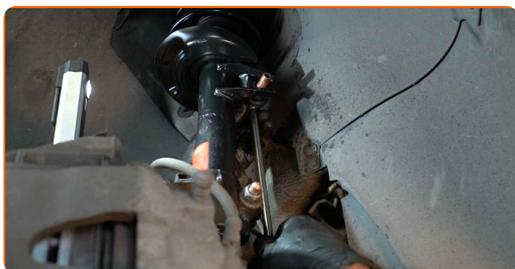
**12** Utiahnite upevňovací prvok vzpery stabilizátora. Použite kombinačný kľúč č.18. Použite nástavec č.18. Použite ráčňový kľúč.
