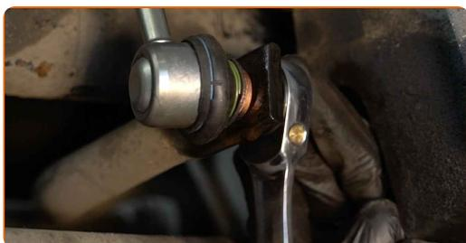
**13** Utiahnite upevnenie spájajúce vzperu stabilizátora k vzpere tlmiča. Použite nástavec č.18. Použite momentový kľúč. Utiahnite ju krútiacim momentom 65 Nm.
