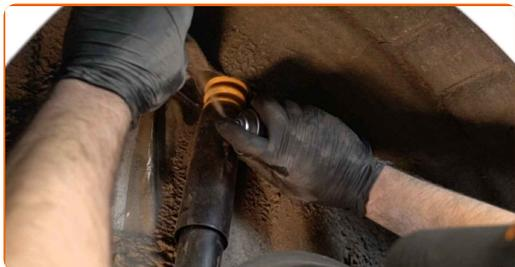
**33** Utiahnite spodné upevnenie tlmiča. Použite nástavec č.18. Použite momentový kľúč. Utiahnite ju krútiacim momentom 120 Nm.
