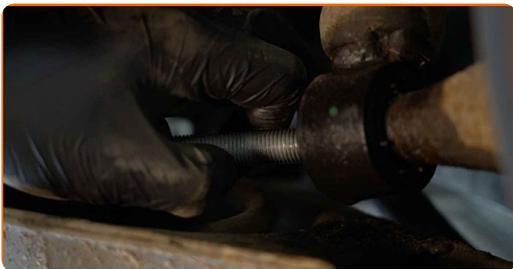
**13** Odskrutkujte vrchné upevnenie tlmiča. Použite nástavec č.16. Použite ráčňový kľúč.
