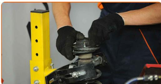
**35** Upevnite maticu piestu vzpery tlmiča. Použite nástavec č.18. Použite imbusový kľúč č. H6. Použite ráčňový kľúč. Použite momentový kľúč. Utiahnite ju krútiacim momentom 50 Nm.
