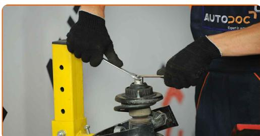
Výmena: jednotka pruženia, tlmič pruženia – Audi A4 B5 Avant. Tip od AUTODOC:
