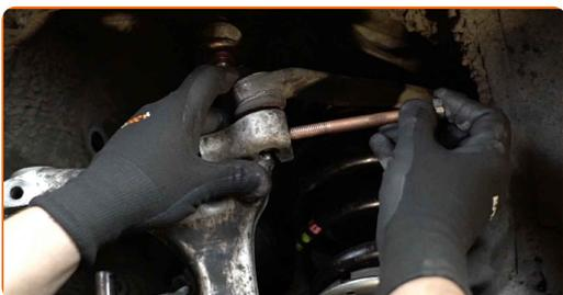
**50** Utiahnite upevnenie vrchného ramena. Použite kombinačný kľúč č.17. Použite nástavec č.17. Použite momentový kľúč. Utiahnite ju krútiacim momentom 40 Nm.
