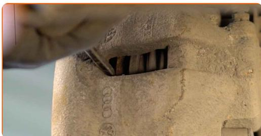
**10** Odstráňte brzdový strmeň. Použite páčidlo.
