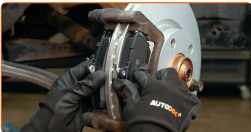
**26** Nainštalujte brzdový strmeň a upevnite ho. Použite kombinačný kľúč č.15. Použite nástavec č.13. Použite momentový kľúč. Utiahnite ju krútiacim momentom 30 Nm.
