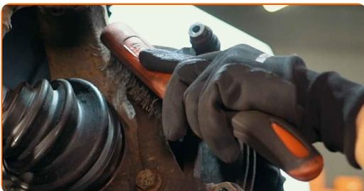
**14** Odskrutkujte upevnenie svorky brzdového strmeňa. Použite nástavec č.17. Použite ráčňový kľúč. Použite vratidlo.
