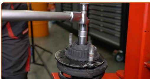
Výmena: jednotka pruženia, tlmič pruženia – Alfa Romeo 147 937. AUTODOC odporúča:
