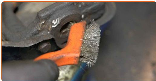
**64** Vyčistite drážky homokinetického kĺbu hnacieho hriadeľa. Použite drôtenú kefu. Použite sprej WD-40.
