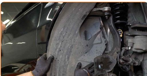
**81** Nainštalujte a utiahnite upevňovacie prvky krytu oblúku kola. Použite krížový skrutkovač PH.
