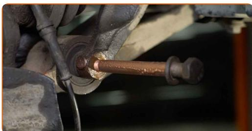
**76** Zaskrutkujte upevňovací prvok spájajúci vidlicu tlmiča odpruženia k spodnému ovládacímu ramenu. Použite kombinačný kľúč č.19. Použite nástavec č.19. Použite ráčňový kľúč.
