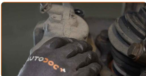
**97** Nainštalujte zádržnú pružinu brzdového strmeňa. Použite páčidlo.
