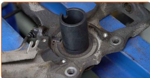
**53** Vyčistíte montážní otvor ložiska náboja. Použijte drôtenú kefu. Použijte sprej WD-40.
