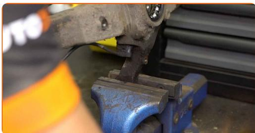
**49** Vyčistite montážny otvor ložiska náboja. Použite drôtenú kefu. Použite sprej WD-40.
