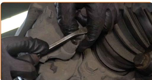
**12** Odskrutkujte upevnenie brzdového strmeňa. Použite imbusový kľúč č. H7. Použite ráčňový kľúč.
