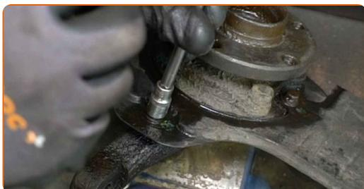
**44** Odstráňte kryt brzdového kotúča.
