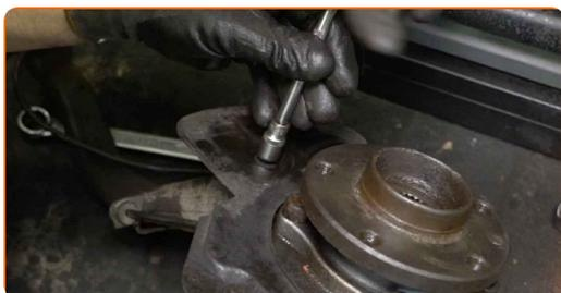
**63** Natrite montážny prvok vzpery tmiča na hlave ložiska čapu kola. Použite drôtenú kefu. Použite sprej WD-40.
