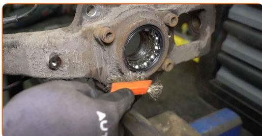
**50** Odsrutkujte upevnenie, ktoré spája ložisko náboja kolesa k hlave ložiska čapu kolesa. Použite imbusový kľúč č. H8. Použite ráčňový kľúč. Použite vratidlo.
