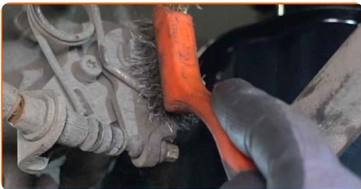
**6** Odpojte lanko parkovacej brzdy od brzdového strmeňa. Použite páčidlo. Použite kliešte na vodnú pumpu.
