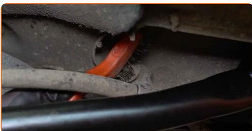
**8** Odskrutkujte upevnenie lanka parkovacej brzdy. Použite kombinačný kľúč č.10.
