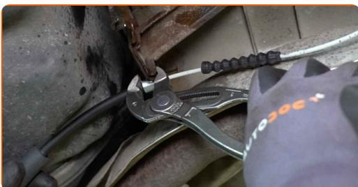
**21** Pripevnite lanko parkovacej brzdy ku karosérii auta.
