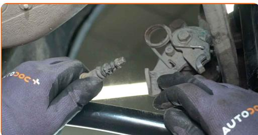
**7** Vyčistite upevňovací prvok lanka parkovacej brzdy. Použite drôtenú kefu. Použite sprej WD-40.
