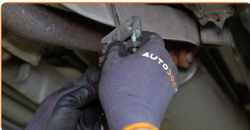
**18** Vyčistite montážne pozície lanka parkovacej brzdy. Použite drôtenú kefu. Použite sprej WD-40.
