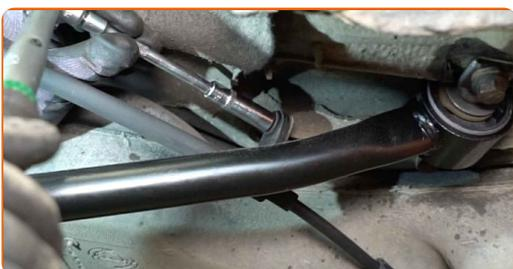
**23** Vyčistite upevňovací prvok lanka parkovacej brzdy. Použite drôtenú kefu. Použite viacúčelový čistiaci sprej.
