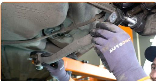
**12** Vyčistite montážne otvory a závit ramena odpruženia. Použite drôtenú kefu. Použite sprej WD-40.
