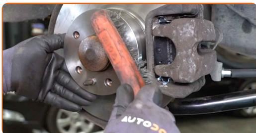
**22** Natrite povrch, kde je brzdový kotúč v kontakte s ráfikom kola. Použite medené mazivo.
