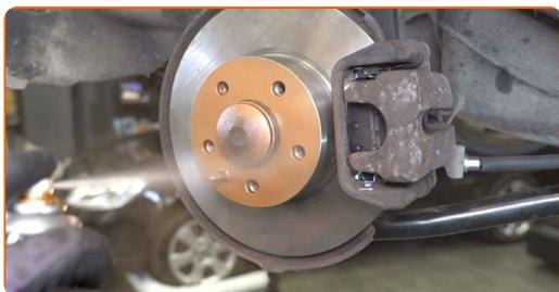
**23** Vyčistíte povrch brzdového kotúča. Použite čistič brzd.
