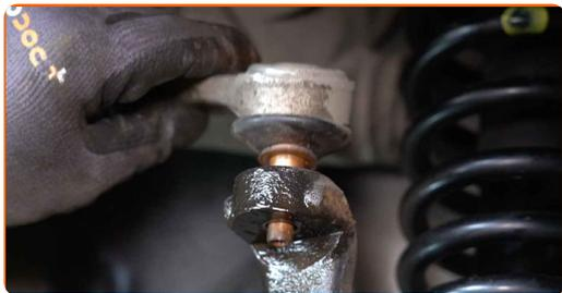
**44** Zaskrutkujte upevnenie, ktoré spája rameno zavesenia kolies k hlave ložiska čapu kolesa. Použite nástavec č.17. Použite ráčňový kľúč.
