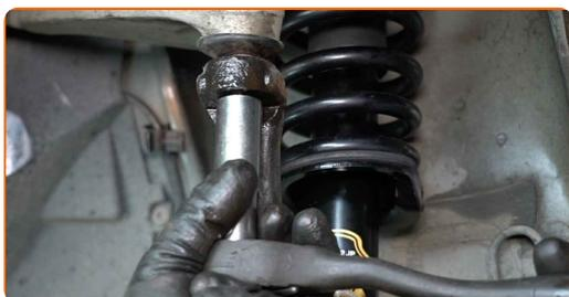
**45** Vyčistite montážne pozície vzpery stabilizátora. Použite drôtenú kefu. Použite sprej WD-40.
