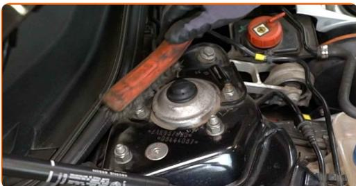
**4** Odskrutkujte vrchné upevňovacie prvky tlmiča. Použite nástavec č.17. Použite ráčňový kľúč.
