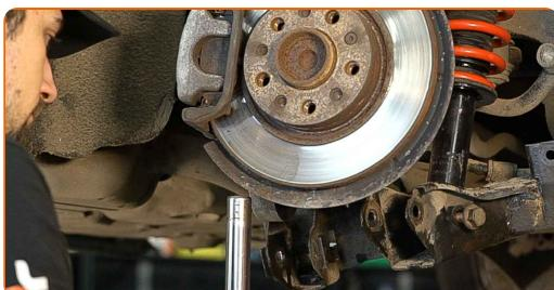
Výmena: jednotka pruženia, tlmič pruženia – ALFA ROMEO Brera (939\_). Tip od AUTODOC:
