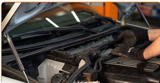
**12** Zaskrutkujte upevňovacie skrutky uloženia filtra. Použite hviezdicový Torx T20. Použite ráčňový kľúč.
