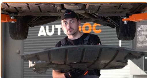
**24** Utiahnite upevnenia spodného krytu olejovej vane. Použite nástavec č.8. Použite ráčňový kľúč.
