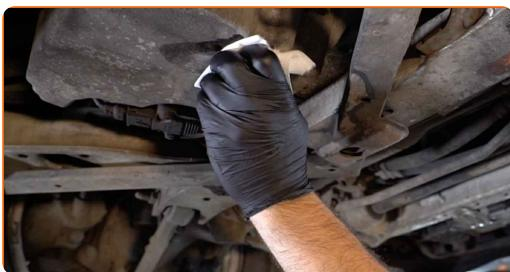
**23** Znovu namontujte spodný kryt olejovej vane.
